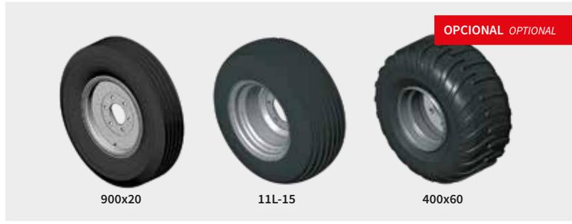
Opcional: neumático simples 900 x 20 y/o 400x60 para CRSG 32 hasta 48 discos. Neumático simples 11L x 15 para CRSG 18 hasta 28 discos. Neumático simples 7.50 x 16 para CRSG 12 hasta 16 discos.
