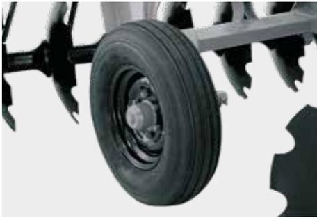
Ruedas simples con neumáticos 6.00x16 para CRSG 12-16 discos. Ruedas simples con neumáticos 7.50x16 para los modelos CRSG 18-28 discos.
