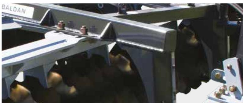
Vigas tubulares de alta resistencia.
