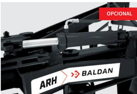
Sistema de reversión a través de pistón hidráulico para el modelo ARH (L).
